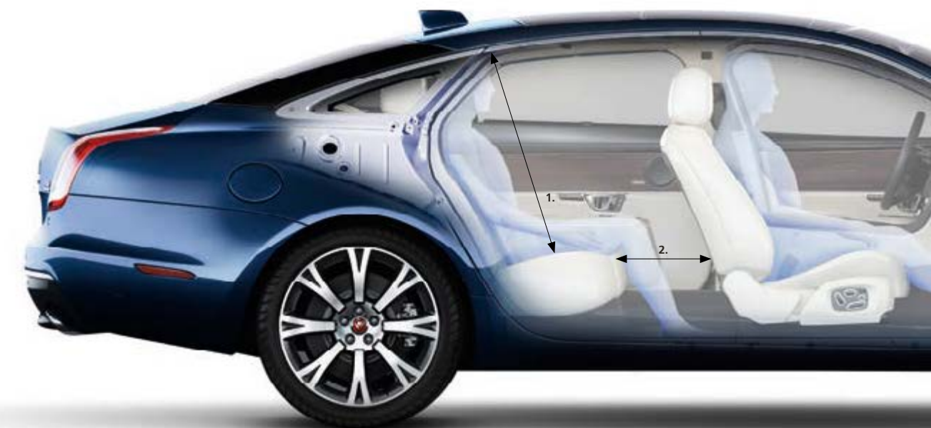
1. Висота стелі (в комплектаціях з подовженою колісною базою) 960 мм 2. Простір для колін (в комплектаціях з подовженою колісною базою) 189 мм
